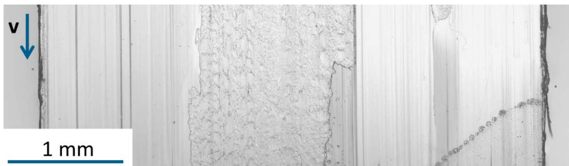
Bild 1: Kontaktfläche eines PEEK-Grundkörpers nach beendetem Stift-Scheibe-Triboversuch
