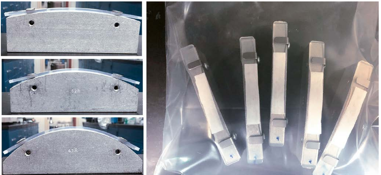
Zugstäbe, montiert auf Vorrichtungen bei den unterschiedlichen Dehnraten 0,5 %, 1 % und 1,5 % (links, von oben nach unten). Rechts: die Prüfstäbe mit aufgelegten Tüchern, getränkt mit den entsprechenden Prüfmitteln, u. a. IPA/Wasser, Desinfektionsmittel, Chemotherapeutikum (© Evonik Cyro)
