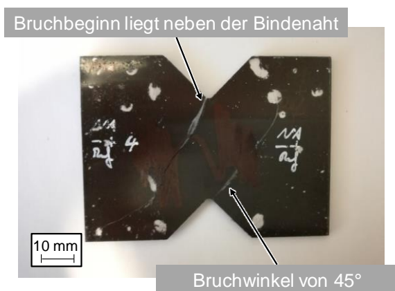
Bild 9: Exemplarischer Schubprobekörper nach Versagen
