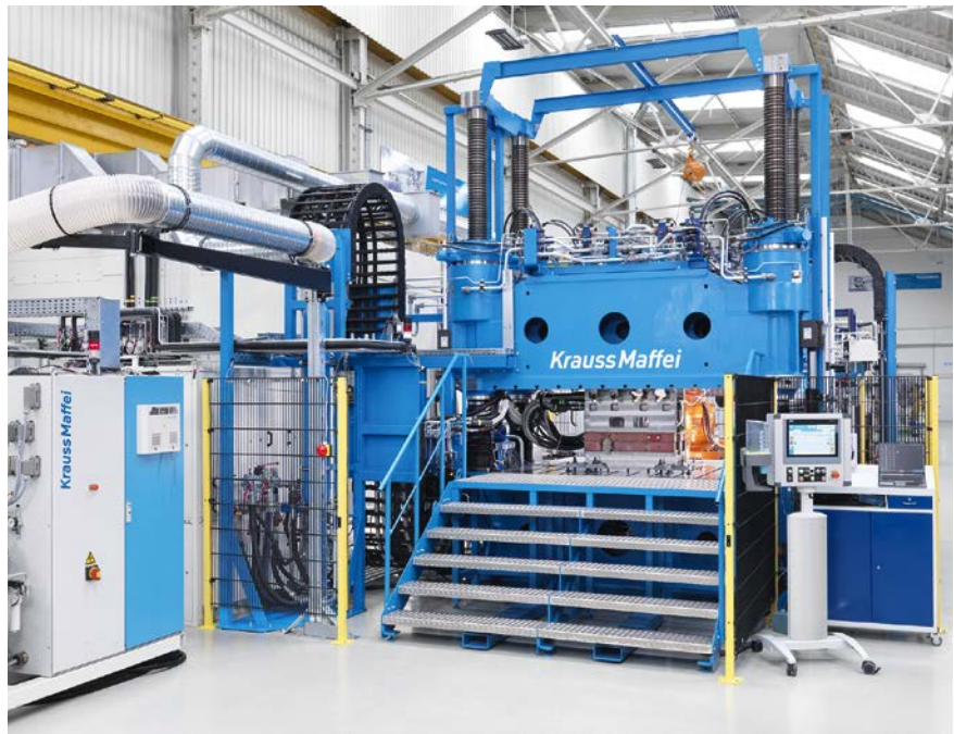
Bild 5. Automatisierte Nasspress-Produktionsanlage für den Serienbetrieb: Erstmals wird das Verfahren mit PUR-Material und einem automatisierten Handling der Faserplatten vorgestellt (© KraussMaffei)
