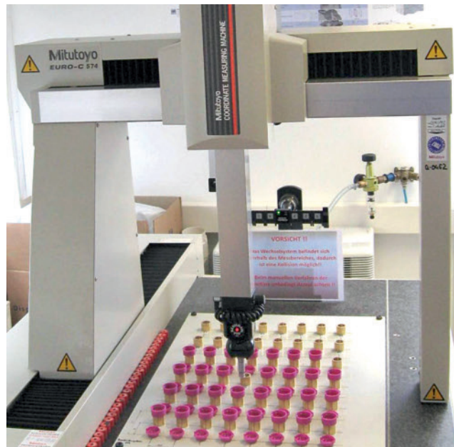
Bild 1. Die Qualität der Flaschenverschlüsse wird mit einem 3D-Koordinatenmesstisch geprüft
