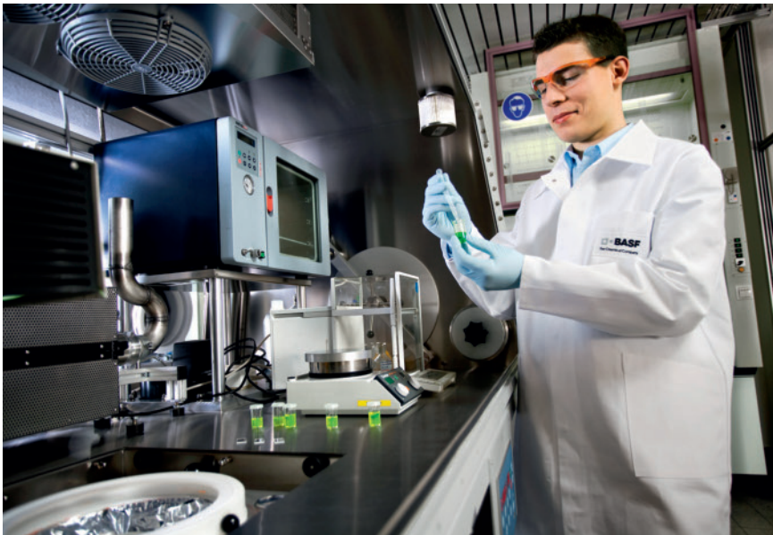
Bild 3. Solarzellentechnologie auf Basis organischer Materialien: Christian Dörr, Laborant, setzt eine organische Halbleiterlösung für das sogenannte Spincoating an
