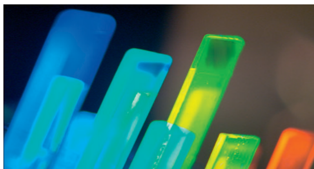
Bild 1. Unter UV-Licht werden phosphoreszierende Emittermaterialien für Organische Leuchtdioden (OLEDs) getestet. Eingebaut in OLEDs bieten sie ganz neue Beleuchtungsmöglichkeiten – wie Fenster als transparente Lichtquellen
