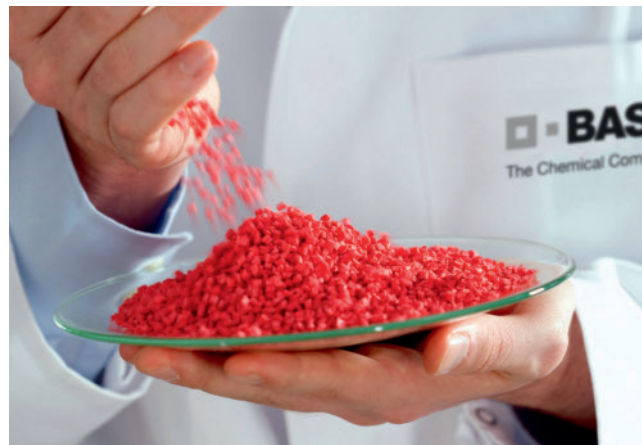
Bild 4. Mit Ultradur High Speed, einem auf Basis der Nanotechnologie entwickelten PBT, haben Forscher der BASF einen leistungsfähigen technischen Kunststoff entwickelt
